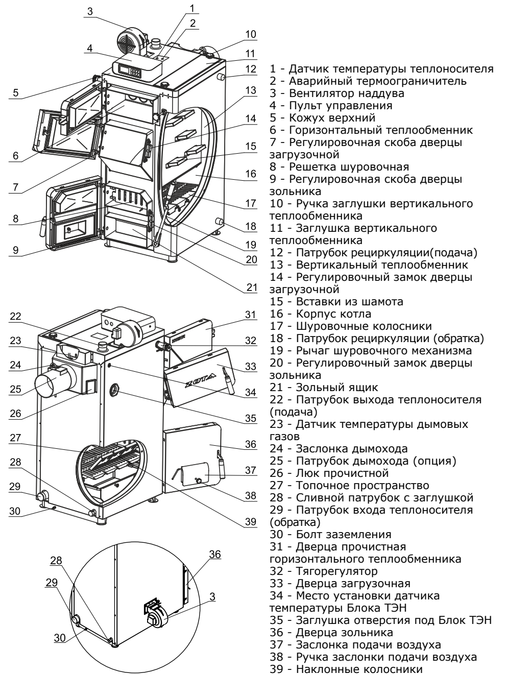
Установка вентилятора наддува на котел ZOTA Magna 45 кВт
